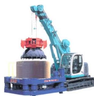
(参考) 推進工とは、河川等の障害物の下側にトンネルを掘る工事であり、今回は道路下約5mに内径50cmのトンネルを掘り、内径30cmの水道管を入れます。
